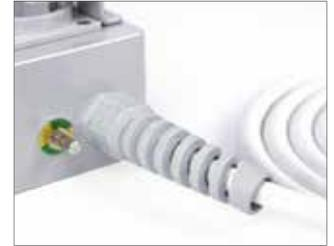
Zusätzlicher Potential-ausgleich (ZPA) am Gehäuse, und 11 mm starkes Stromkabel mit je 2,5 mm<sup>2</sup> Einzeladern und Knick-schutz am Gehäuse.
